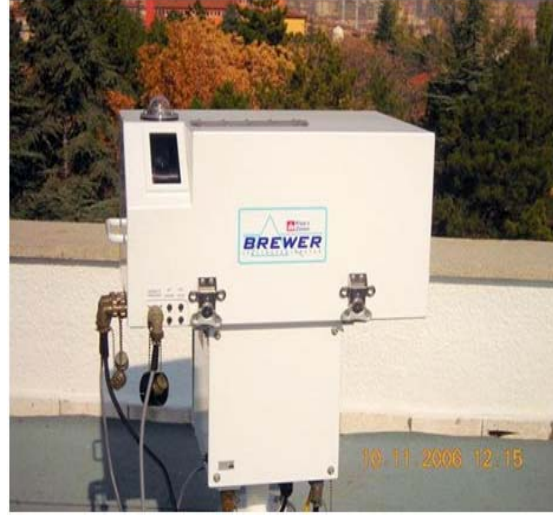
Şekil 3. WOUDC ozon gözlem ağı ve Ankara'da kurulu Brewer Spektrofotometresi (188)
