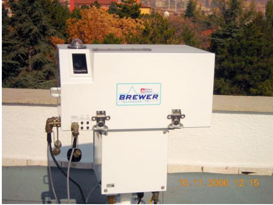
Meteoroloji Genel Müdürlüğünde Kurulu Brewer Spektrofotometresi (B188)
