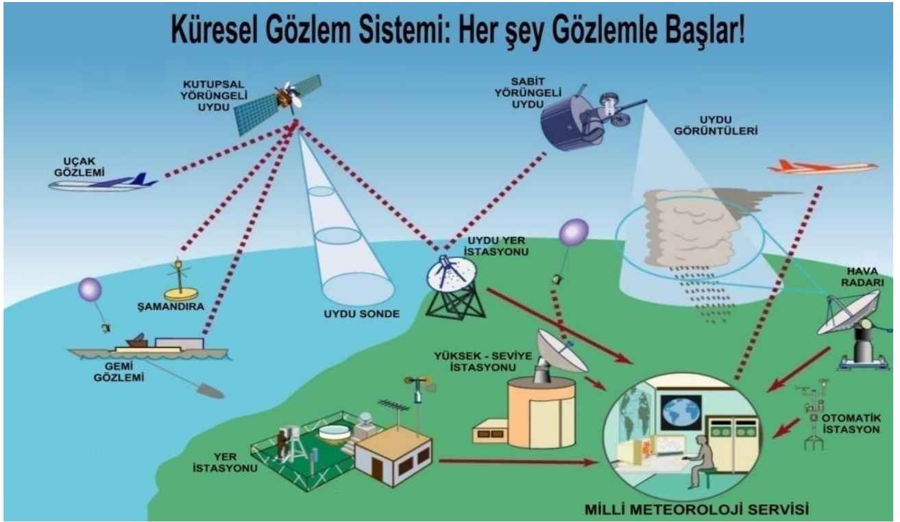
Şekil 3: Küresel Gözlem Sistemi
